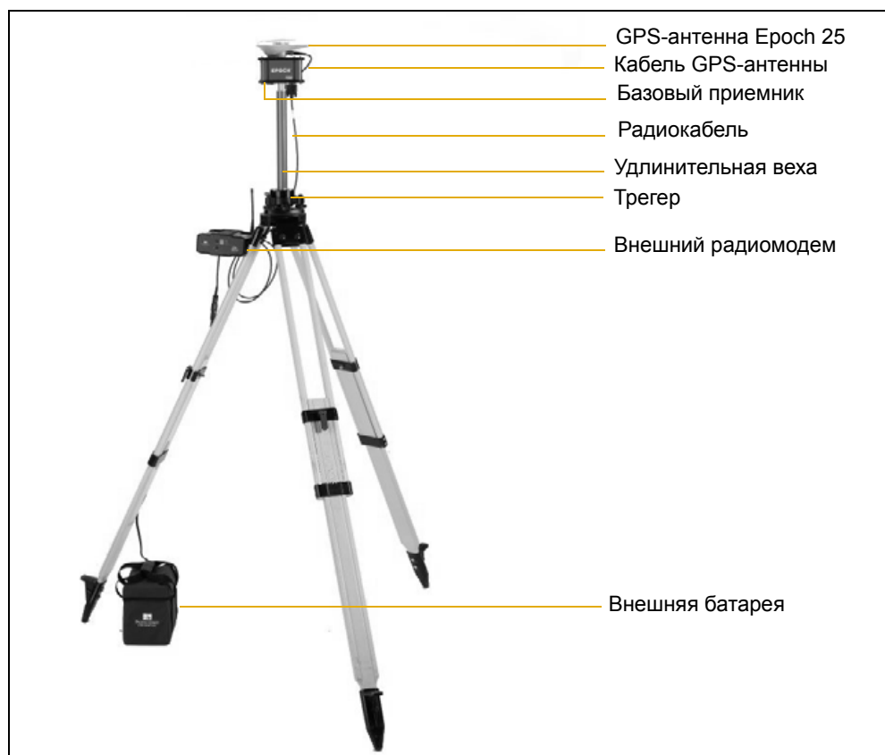
Рисунок 2.3 GPS-приемник Epoch, установка базы
